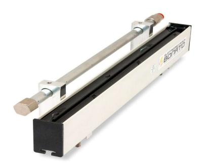
La barra antistatica IDB-S è accoppiata ad un tubo forato in corrispondenza di ogni emettitore, in modo tale da poter portare l'aria ionizzata ad una maggiore distanza.
