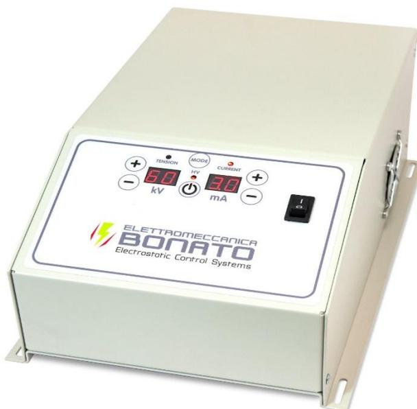
El generador de carga ECG60 genera alto voltaje ajustable entre 5 y 60KV con una corriente máxima de 3.0mA, puede funcionar en modo de voltaje constante o corriente constante. Sus controles son muy intuitivos y, por lo tanto, fáciles de usar por parte del operador. Además, el generador se puede controlar de forma remota a través de la función de control remoto analógico, puede tener una carga positiva o negativa y tiene 4 salidas de alto voltaje.
