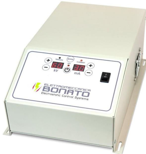
Der Aufladungsgenerator ECG60 erzeugt eine zwischen 5 und 60 kV einstellbare Hochspannung mit einem maximalen Strom von 3,0 mA, er kann im Konstantspannungs- oder Konstantstrommodus arbeiten. Seine Steuerung ist sehr intuitiv und daher leicht durch den Bediener zu verwenden. Darüber hinaus kann der Generator über seine analoge Fernsteuerfunktion ferngesteuert werden, er kann positiv oder negativ geladen werden und verfügt über 4 Hochspannungsausgänge.
