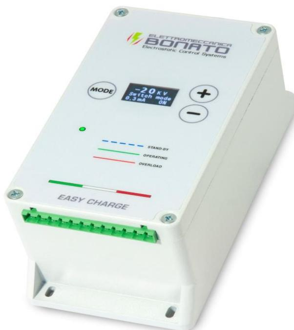
Le générateur de charge **EASY CHARGE** crée une haute tension réglable entre 0 et 20 KV et un courant également réglable entre 0 et 1,0 mA.
