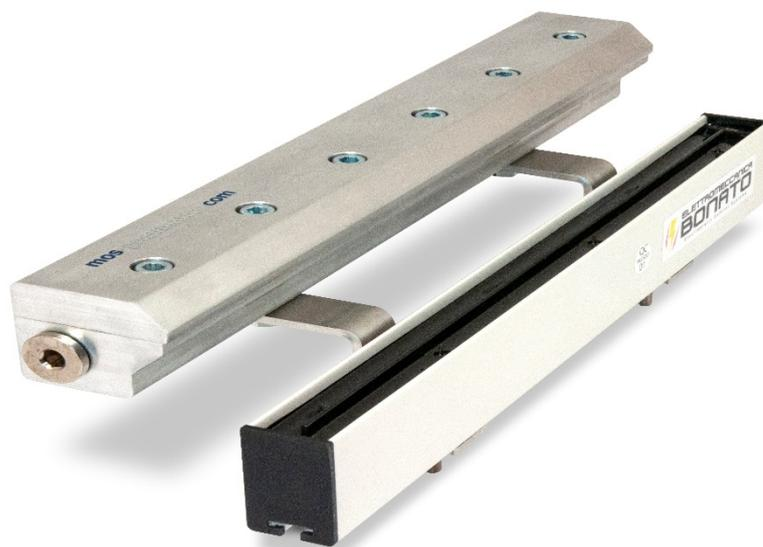
La barre antistatique IDB-AKM est une barre antistatique couplée à une lame d'air. La lame d'air est un amplificateur du débit d'air, en fait elle amplifie environ 30 fois le débit d'air comprimé utilisé, de cette façon il y a une grande économie d'énergie en termes d'électricité pour produire de l'air comprimé.
