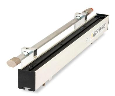
La barra antiestática IDB-S está acoplada a un tubo perforado en correspondencia con cada emisor, para poder llevar el aire ionizado a mayor distancia.
