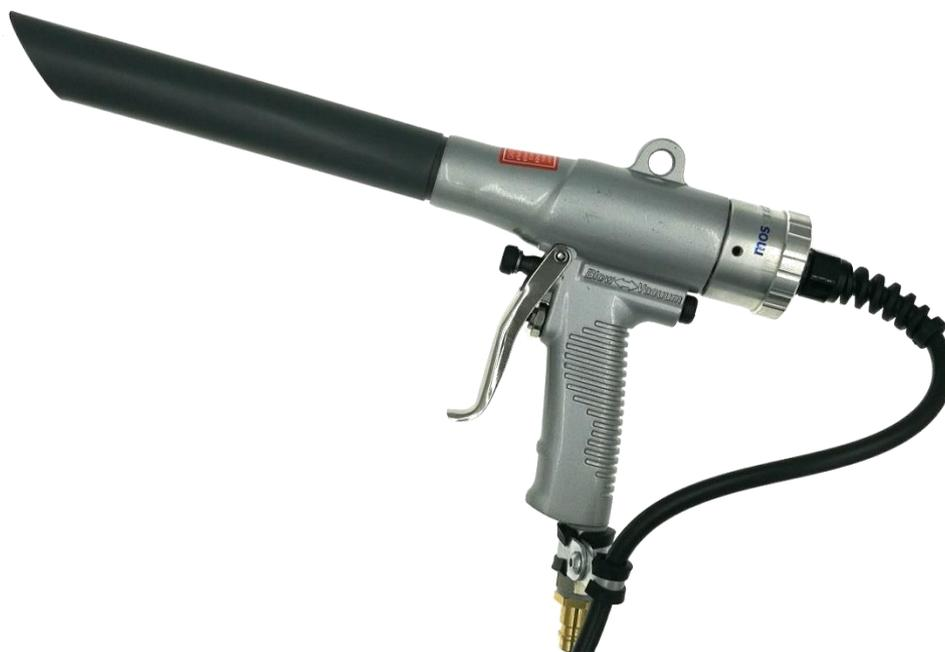
AG-02 — это антистатический трансвекторный пистолет для продувки сжатым воздухом, который удаляет электростатические заряды. Ионизирующий стержень является безопасным при контакте и надёжно защищён прочным корпусом пистолета. Это позволяет потоку воздуха ионизироваться при нажатии на спусковой крючок.
