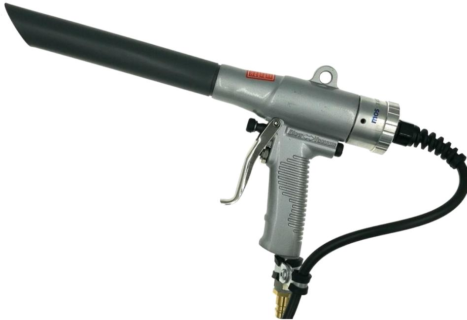
AG-02 是一款可去除静电荷的横传式抗静电气枪。电离针是抗冲击的，此外，针由坚固的枪身保护。这会在按下扳机时使气流电离。
