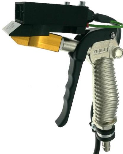
AG-03防静电枪的扁平喷嘴带有细小的防静电棒。电离针是抗冲击的。当压缩空气离开扁平喷嘴的窄槽时，风量被周围空气放大。这种压缩空气吸收离子并将它们直接带到产品表面。枪中的电离针和扁平喷嘴的组合可以有效去除静电荷，同时**噪声和压缩空气消耗量极低**。该枪符合人体工程学且坚固耐用，并随附有各种长度的高压电缆，**必须**连接到电源。
