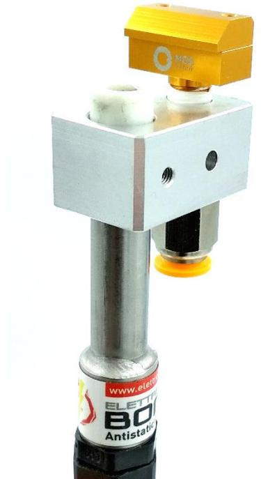
压缩空气电离喷嘴具有双重功能，它们清洁感兴趣的表面并消除现有的静电荷。电离喷嘴用于安装条件困难的地方，尤其是在狭窄的空间中。我们的电离喷嘴可以有多种配置，也可以根据客户需要串联成圆形。
