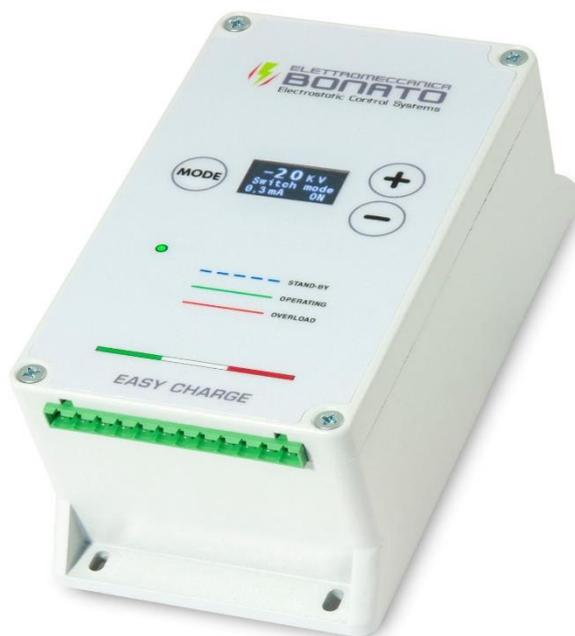
电荷发生器Easy Charge(轻松充电)产生在 0 到 20 kV 之间可调的高压也产生在 0 到 1.0毫安之间可调的电流，其控件非常直观，因此操作员易于使用，这要归功于 oled 显示屏您可以在其中读取瞬时电压和电流以及工作模式，此外还可以通过模拟遥控功能远程控制发电机，它可以根据要求提供正电荷或负电荷以及 2 个高压输出。
