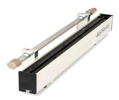
Антистатический ионизатор IDB-S оборудован прорезной трубой на уровне каждого эмиттера, что позволяет перемещать ионизированный воздух на большие расстояния. Поскольку эмиттеры подсоеденины посредством резистора к источнику высокого напряжения, риск для здоровья рабочего, в случае случайного прикосновения, отсутствует, что позволяет получить максимально эффективную работу прибора.
