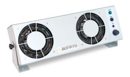
Ионизирующий вентилятор IF-02 был разработан для быстрого снятия антистатических зарядов и доведения до состаяния +/- 3 В. Излучатели вентилятора подключены посредством резистора высокого напряжения и покрыты эпоксидной смолой для максимального ионизирующего эффекта и для безопасного контактирования с ними. Конструкция ионизатора позволяет легко очищать излучатели.
