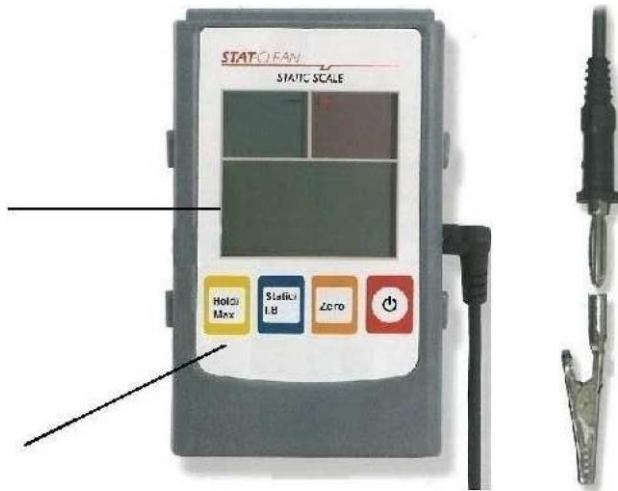
Indicador digital de voltaje de carga electrostática desde 0 hasta \pm 22 kv
