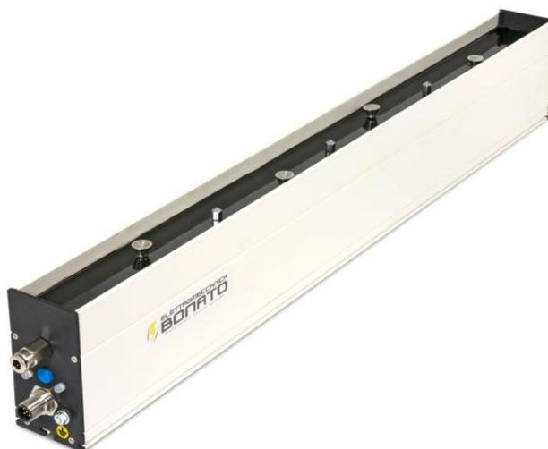
Антистатический ионизатор IDB-35-S (без удара электрическим током) был разработан для разряда поверхностей на дальних расстояниях. Благодаря соплам для сжатого воздуха, ионы, создаваемые ионизатором, могут удалять электростатические заряды на расстоянии до 2500 мм.
