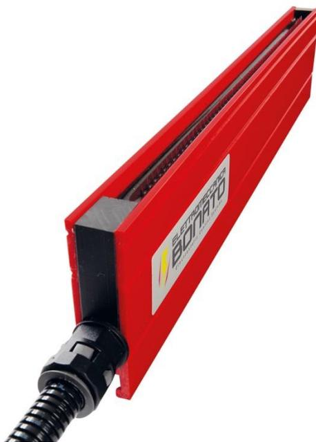
La barre de charge électrostatique CBR-15 à profil bas a la fonction de faire adhérer un matériau à une surface ou deux matériaux l'un à l'autre. Ces barres de charge sont connectées à un générateur haute tension générant de l'haute tension afin que des ions (positifs ou négatifs) se créent sur les pointes de la barre. Par conséquent, lorsque le matériau passe entre la barre et une masse de référence, il est poussé vers la masse en créant une adhésion temporaire.
