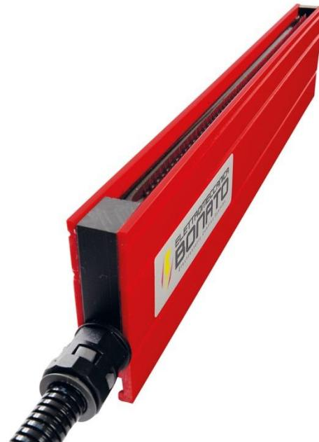
Низкоуровневые панели электростатического заряда **CBR-LP-15** предназначены для обеспечения прилипания материала к поверхности или одного материала к другому. Эти панели электрического заряда подключены к генератору высокого напряжения, который, генерируя высокое напряжение, создаёт ионы (положительные и отрицательные) на концах панели, таким образом, перемещаясь между панелью и нулевым проводом, материал перемещается к проводу, создавая временный контакт прилипания.
