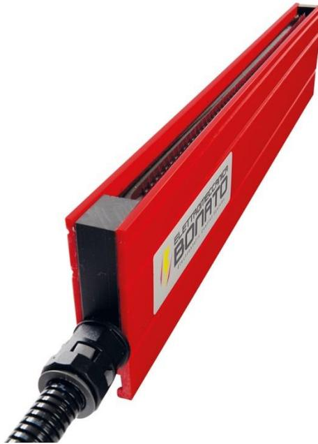
Las barras de carga electrostática **CBR** tienen la función de hacer que un material se adhiera a una superficie o dos materiales entre sí, estas barras de carga se conectan a un generador de alto voltaje, el cual genera el alto voltaje para que se creen iones (positivos o negativos) en las puntas de la barra, luego el material que pasa entre la barra y una masa de referencia es empujado hacia la propia masa creando una adhesión temporal.
