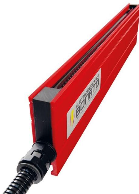
Les barres de charge électrostatique **CBR** ont pour fonction de faire adhérer un matériau à une surface ou à deux matériaux l'un à l'autre, ces barres de charge sont connectées à un générateur haute tension, qui génère la haute tension afin que des ions (positifs ou négatifs) soient créés sur les pointes de la barre, puis le matériau passant entre la barre et une masse de référence est poussé vers la masse elle-même créant une adhérence temporaire.
