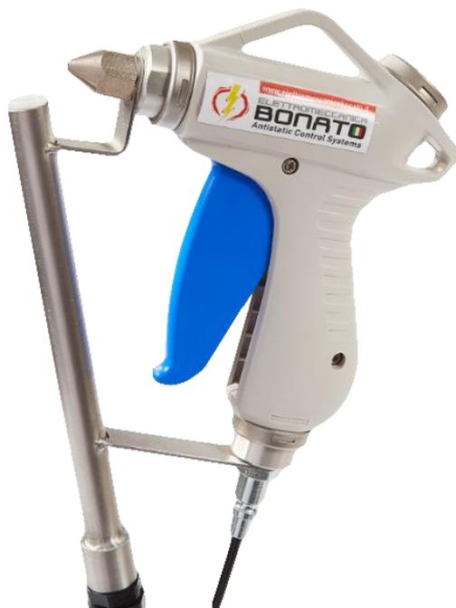
La pistola antistatica AG-01, antiscossa, è una pistola ad aria compressa con accoppiato un ugello emettitore di ioni, questo fa sì che il flusso d'aria che si genera quando si preme il grilletto diventi ionizzato, quindi in grado di eliminare le cariche presenti sulle superfici dove viene indirizzato. Con questo tipo di design la pistola AG-01 è molto efficace rispetto alle pistole con ionizzazione interna oltre che molto maneggevole ed ergonomica.
