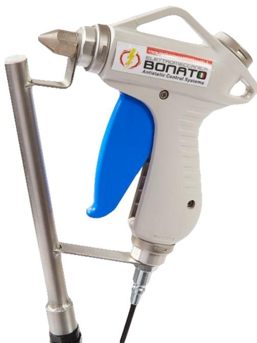
AG-01防触电防静电枪是压缩空气枪加上离子发射器喷嘴，使按下扳机时产生的气流电离，能够消除其指向的表面上存在的电荷。通过这种设计，AG-01枪与内部电离枪相比非常有效，而且非常方便且符合人体工程学。AG-01枪随附有各种长度的高压电缆，必须连接到电源。
