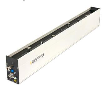
La barre antistatique **IDB-35-S** (shockless) est conçue pour décharger des surfaces sur de longues distances. Les ions générés par la barre, grâce aux buses d'air comprimé, sont capables d'éliminer les courants électrostatiques jusqu'à 2500 mm de distance.
