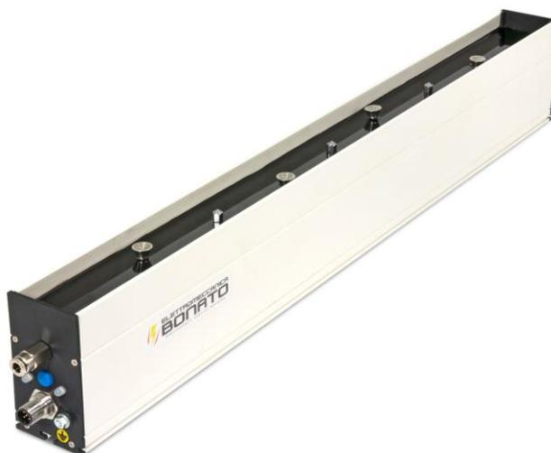
La barra antistatica **IDB-35-S** (senza scossa) è stata progettata per scaricare le superfici a lunghe distanze. Gli ioni generati dalla barra, grazie agli ugelli ad aria compressa, riescono ad eliminare correnti elettrostatiche fino a 2500mm di distanza.
