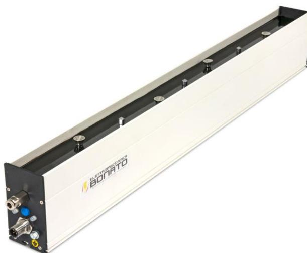
Der Ionensprühstab **IDB-35-S** (stoßfrei) wurde entwickelt, um Oberflächen über große Entfernungen zu entladen. Die vom Stab erzeugten Ionen sind dank der Druckluftdüsen in der Lage, elektrostatische Ströme bis zu einer Entfernung von 2500 mm zu eliminieren.
