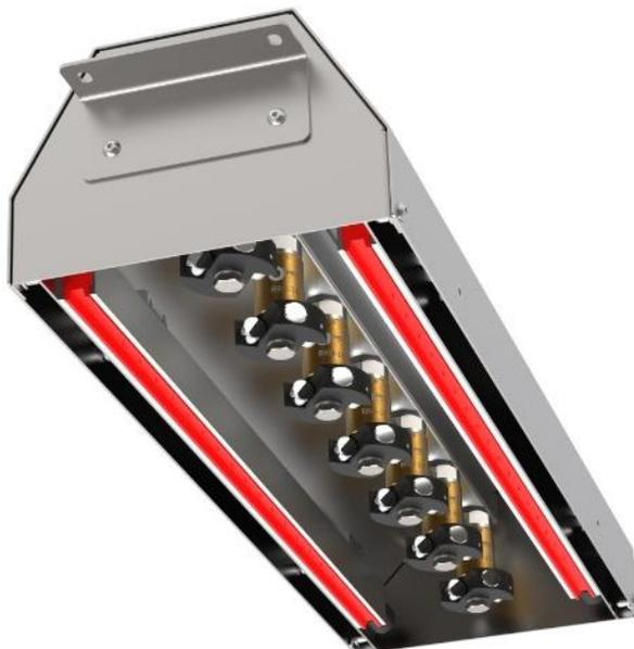
La campana de limpieza ionizante **ICH** es un sistema de limpieza sin contacto adecuado por la limpieza de superficies. El sistema se compone de una estructura de acero inoxidable (campana) que encierra en su interior una fila de boquillas giratorias, 2 barras antiestáticas y 2 ranuras de aspiración colocadas a los lados.
