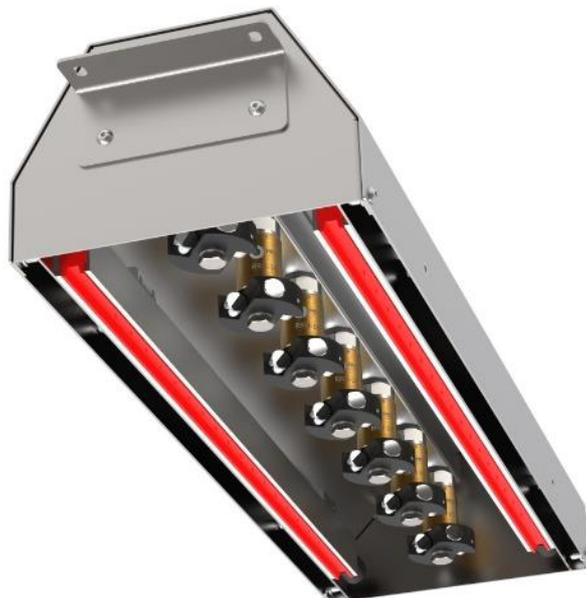
La hotte ionisante de dépoussiérage **ICH** est un système de nettoyage sans contact adapté au nettoyage des surfaces. Le système se compose d'une structure en acier inoxydable (hotte) qui contient une rangée de buses rotatives, 2 barres antistatiques et 2 fentes d'aspiration placées sur les côtés.
