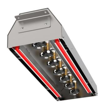
Die ionisierende Reinungshaube **ICH** ist ein berührungsloses Reinigungssystem, das sich für die Reinigung von Oberflächen eignet. Das System besteht aus einer Struktur aus rostfreiem Stahl (Haube), die eine Reihe von Rotationsdüsen, 2 Ionensprühstäben und 2 seitliche Ansaugschlitze umschließt.
