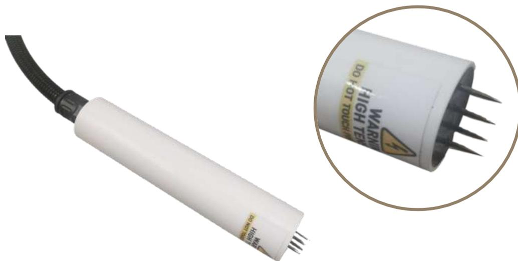
La testina di fissaggio **FH4** è stata studiata per fissare i bordi del film nelle linee di estrusione cast e impedire così che il film raffreddandosi diminuisca la sua larghezza.
