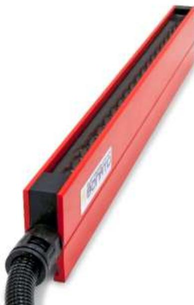
Les barres de charge électrostatique **CBR-LP-10** à profil bas ont pour fonction de faire adhérer un matériau à une surface ou à deux matériaux l'un à l'autre, ces barres de charge sont connectées à un générateur haute tension, qui génère la haute tension afin que des ions (positifs ou négatifs) soient créés sur les pointes de la barre, puis le matériau passant entre la barre et une masse de référence est poussé vers la masse elle-même créant une adhérence temporaire.
