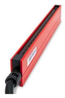
La barre de charge électrostatique **CBR-LP-15** à profil bas a la fonction de faire adhérer un matériau à une surface ou deux matériaux l'un à l'autre. Ces barres de charge sont connectées à un générateur haute tension générant de l'haute tension afin que des ions (positifs ou négatifs) se créent sur les pointes de la barre. Par conséquent, lorsque le matériau passe entre la barre et une masse de référence, il est poussé vers la masse en créant une adhésion temporaire.
