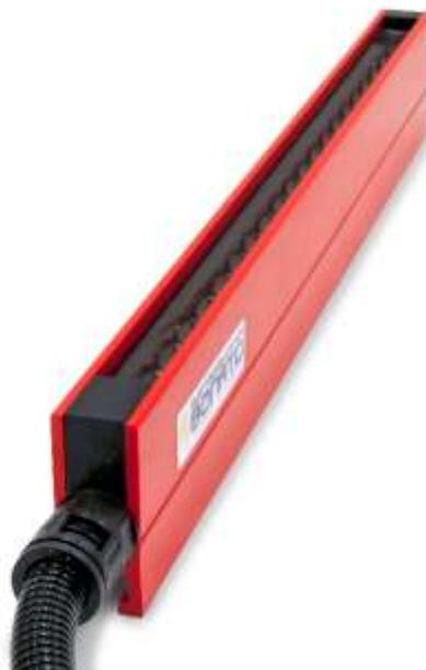
Die elektrostatische Aufladungsleiste **CBR-LP-15** hat die Funktion, ein Material an einer Oberfläche oder zwei Materialien aneinander anliegen zu lassen. Diese Aufladungsleisten sind mit einem Hochspannungsgenerator verbunden, der Hochspannung und gleichzeitig positive oder negative Ionen auf den Leiste-Spitzen erzeugt. Daraus ergibt sich, dass das Material zwischen einer Leiste und einer Bezugsmasse geht und wird gegen dieselbe Masse gedrückt, indem es eine zeitweilige Adhäsion schöpft.
