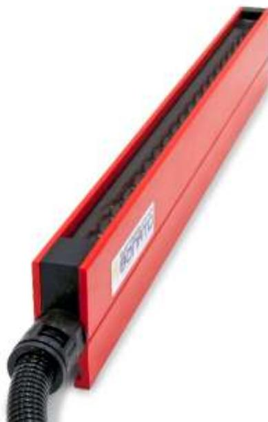
Низкоуровневые панели электростатического заряда **CBR-LP-15** предназначены для обеспечения прилипания материала к поверхности или одного материала к другому. Эти панели электрического заряда подключены к генератору высокого напряжения, который, генерируя высокое напряжение, создаёт ионы (положительные и отрицательные) на концах панели, таким образом, перемещаясь между панелью и нулевым проводом, материал перемещается к проводу, создавая временный контакт прилипания.
