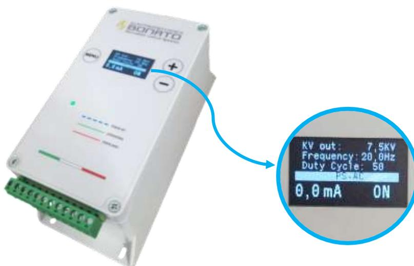
Блок питания PS-AC генерирует регулируемое импульсное напряжение в диапазоне от 1 до 7,5 KV, с регулируемой частотой от 0,5 до 20Hz. Рабочий цикл (duty cycle) также регулируется от 20/80 до 80/20 положительный/отрицательный. Управление очень интуитивно понятное и поэтому простое для оператора, благодаря OLED-дисплею, на котором можно считывать установленное напряжение, частоту и рабочий цикл, а также фактическое потребление тока. Он имеет 2 выхода с переменным напряжением.
