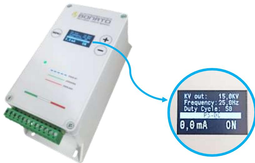
Блок питания PS-DC генерирует регулируемое импульсное напряжение в диапазоне от 0 до 15 Кв, с регулируемой частотой от 0,5 до 25 Гц. Рабочий цикл (duty cycle) также регулируется от 20/80 до 80/20 положительный/отрицательный.
