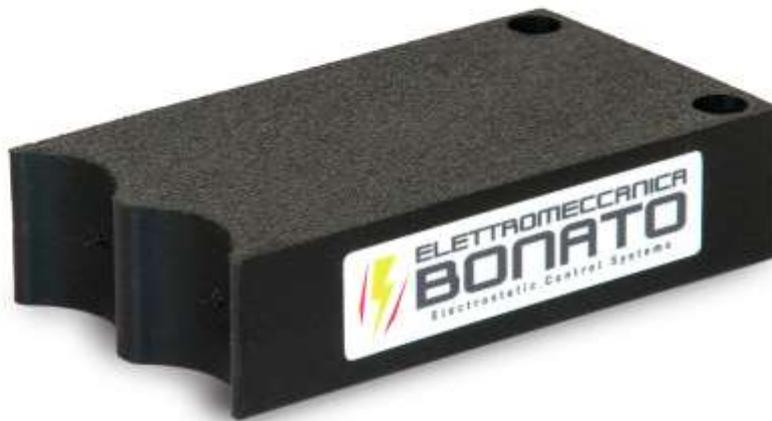
La tête ionisante **IH-DC** est une petite barre antistatique avec alimentation 24Vdc intégrée. Grâce à sa conception compacte, elle est idéale pour toutes les applications où l'espace est limité. Elle ne nécessite pas l'utilisation d'un boîtier d'alimentation externe, mais doit simplement être alimentée à 24V via le connecteur M8 à 4 broches. Elle est équipée d'un indicateur LED qui fournit des informations sur l'état de l'appareil :
