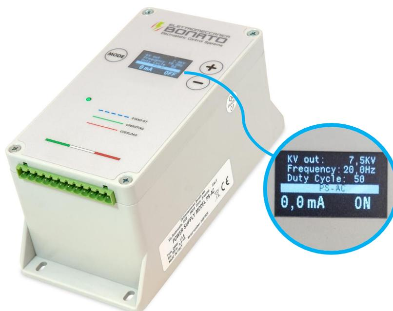
L'alimentatore PS-AC genera una tensione pulsata regolabile tra 1 e 7,5 kV, con una frequenza regolabile da 0,5 a 20Hz. Anche il duty cycle è regolabile da 20/80 a 80/20 positivo/negativo. I comandi sono molto intuitivi e quindi facili da utilizzare dall'operatore grazie anche al display OLED dove si legge sia tensione impostata, frequenza e duty cycle, oltre che al consumo reale di corrente. Ha 2 uscite con tensione alternata.
