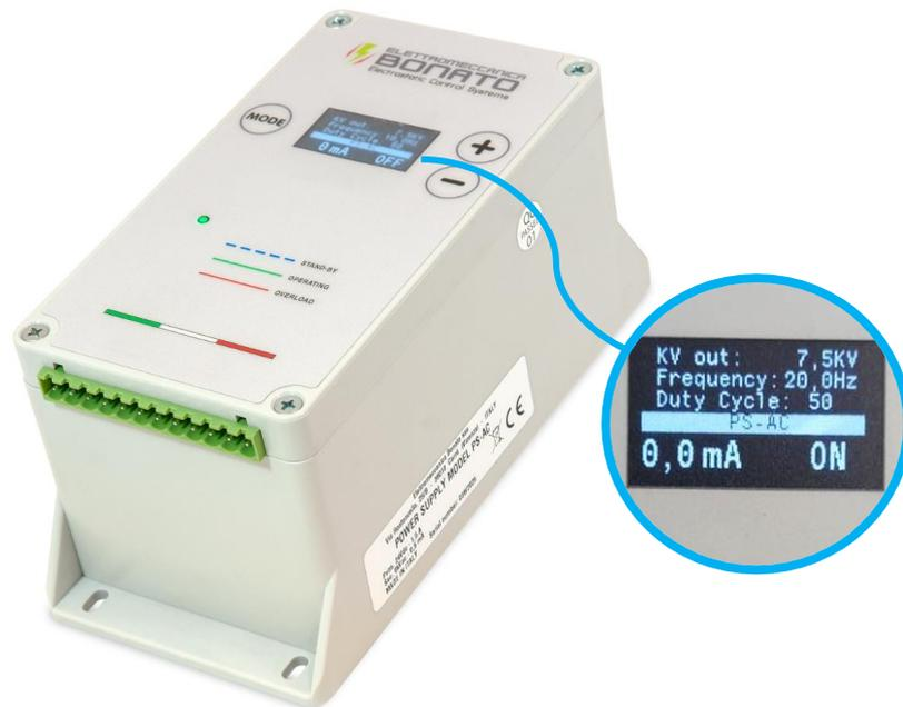
Das PS-AC-Netzteil erzeugt eine einstellbare Impulsspannung zwischen 1 und 7,5 kV, mit einer einstellbaren Frequenz von 0,5 bis 20 Hz. Das Duty Cycle (Tastverhältnis) ist ebenfalls einstellbar von 20/80 bis 80/20 positiv/negativ.
