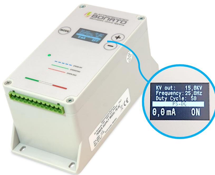
L'alimentatore PS-DC genera una tensione pulsata regolabile tra 0 e 15 kV, con una frequenza regolabile da 0,5 a 25Hz. Anche il duty cycle è regolabile da 20/80 a 80/20 positivo/negativo. I comandi sono molto intuitivi e quindi facili da utilizzare dall'operatore grazie anche al display OLED dove si legge sia tensione impostata, frequenza e duty cycle, oltre che al consumo reale di corrente. Ha 2 uscite una positiva e l'altra negativa.
